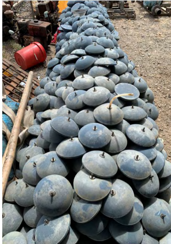
空気送入の為 池底に設置する器具
